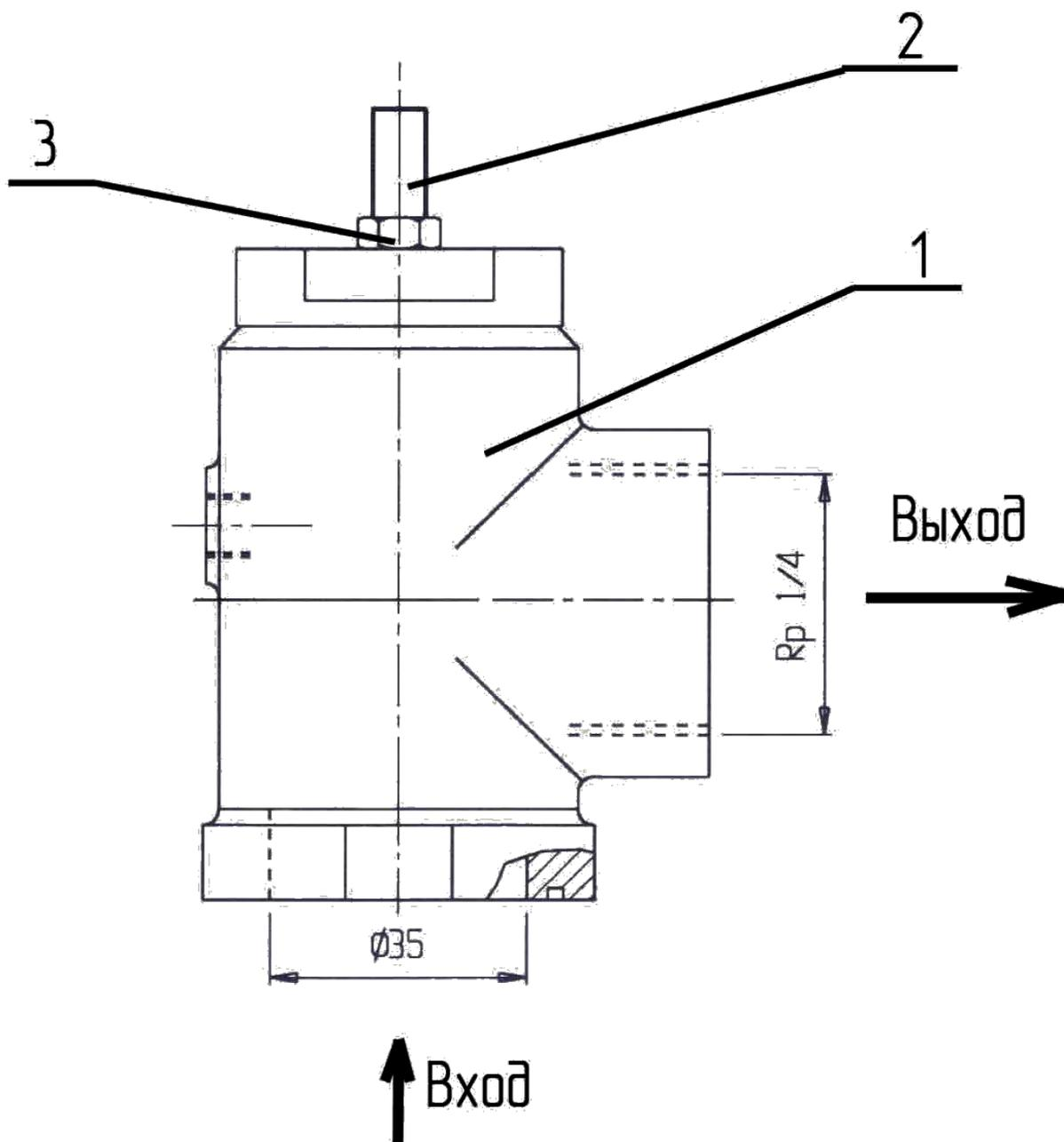
1 – корпус; 2 – регулировочный винт; 3 – контргайка;
