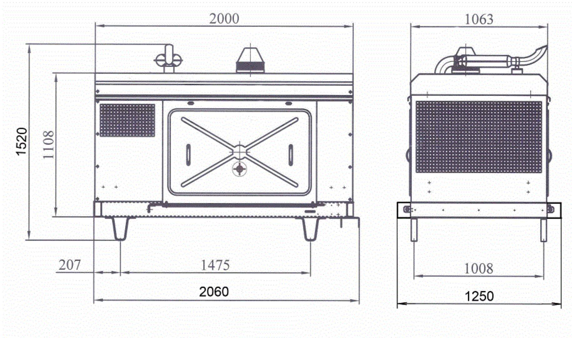
**Рисунок В.1 - Габаритный чертеж компрессорных станций ЗИФ-ПВ6/0,7 (МЗА9-21) и ЗИФ-ПВ8/0,7 (МЗА9-22). Исполнение на раме.**
