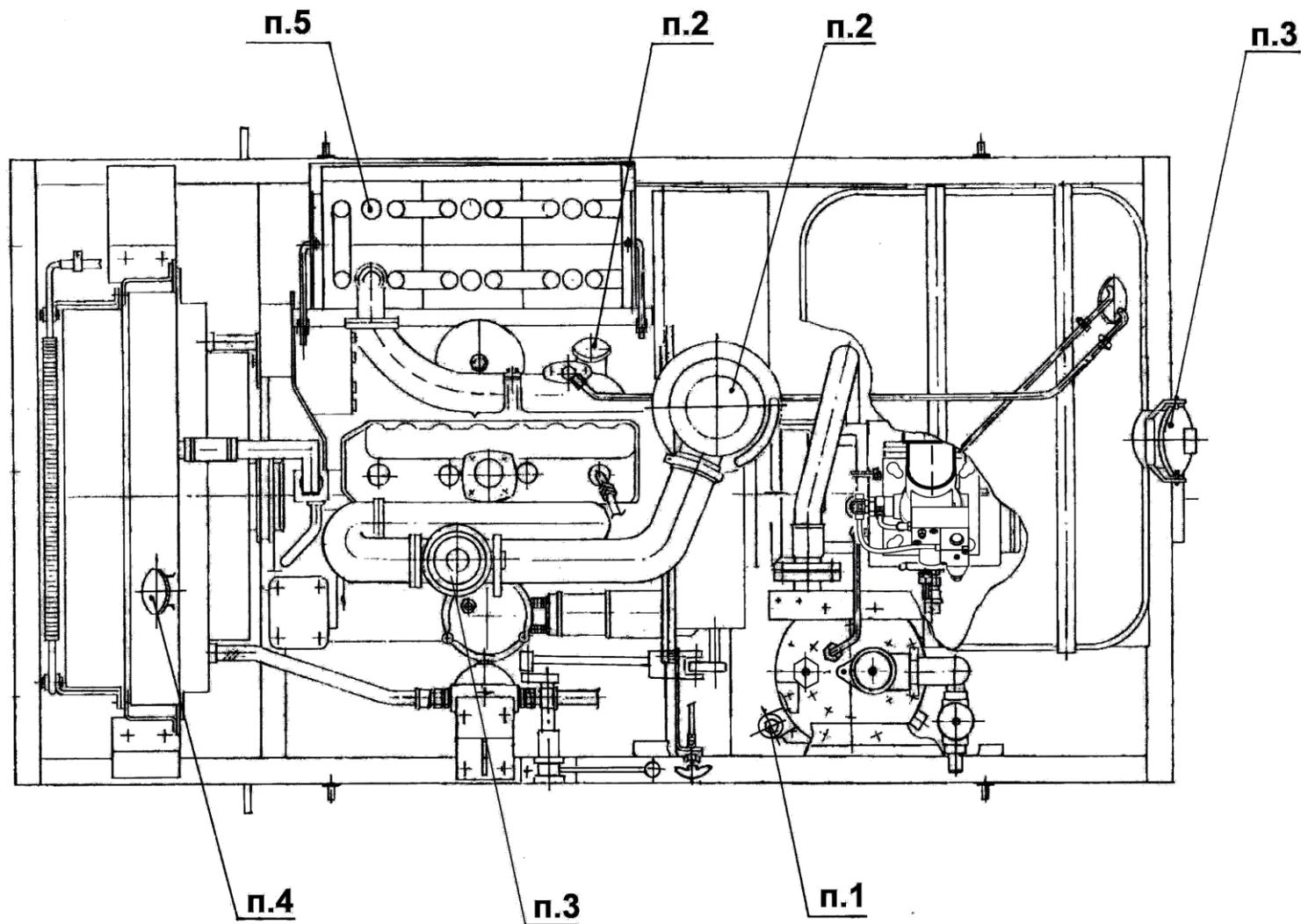
**Рисунок В.15 - Схема заправки компрессорной станции
